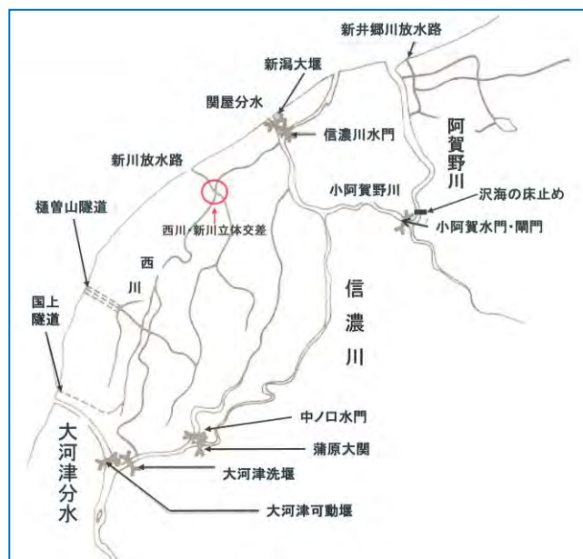
図 14・信濃川・阿賀野川の分派点の堰・水門
