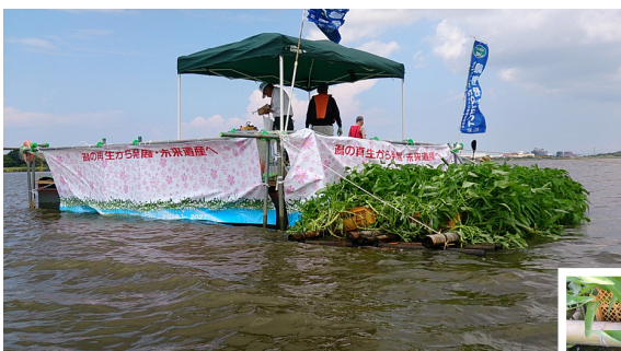
○浮島での水質生物浄化研究:親松排水機場近くでの水質データで365日のチッソ負荷量と空芯菜栽培での吸収力の計算。空芯菜栽培53t分の負荷量があることから5.3t栽培で10%軽減できる。(吉川夏樹新潟大学農学部准教授の試算)
